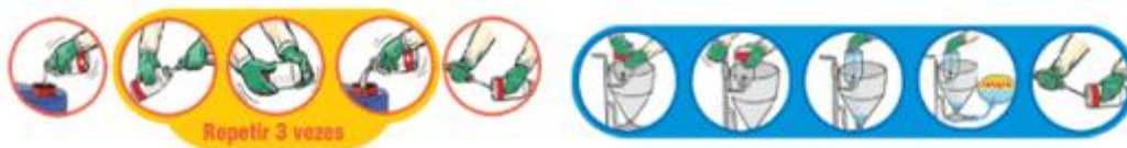
FIGURA: TRÍPLICE LAVAGEM E LAVAGEM PRESSÃO DAS EMBALAGENS DE AGROTÓXICO.
