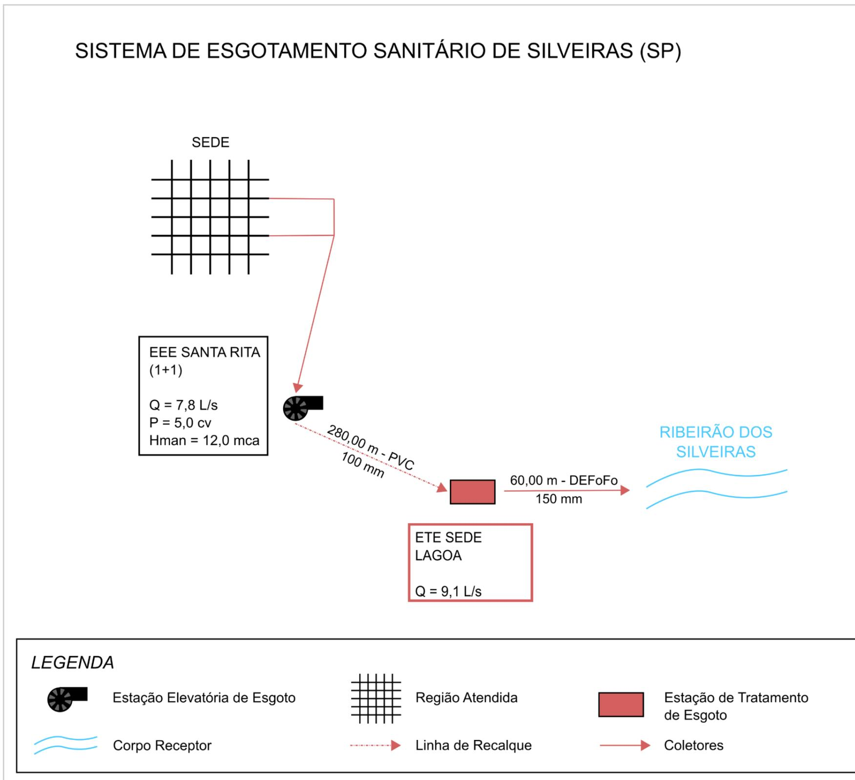
Figura 4.3 – Croqui do Sistema de Esgotamento Sanitário da Sede de Silveiras.
