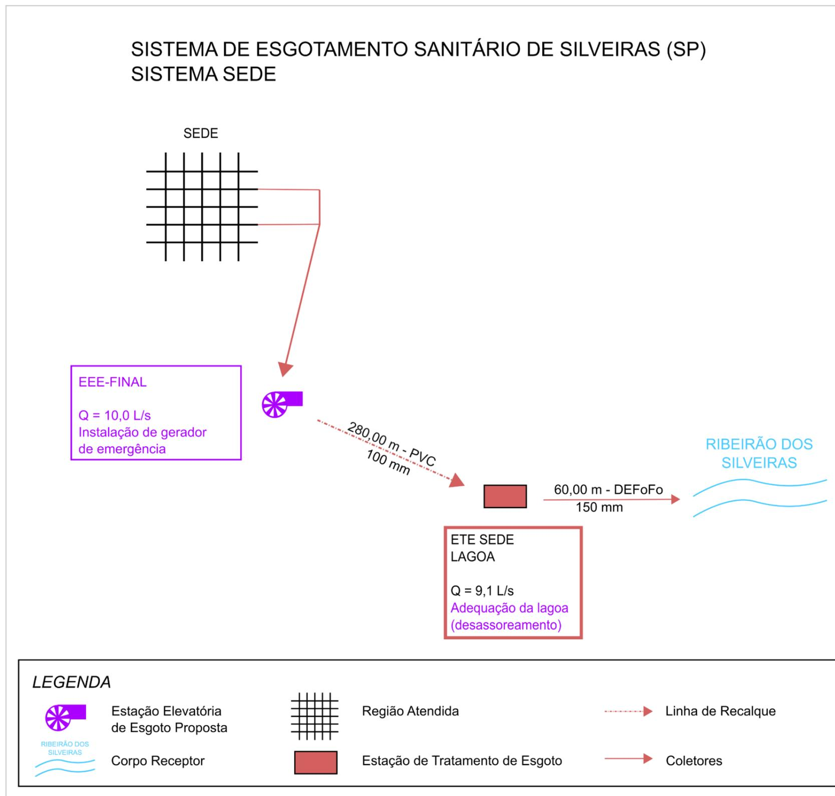
Figura 10.4 – Croqui do Sistema de Esgotamento Sanitário proposto para Sede.
