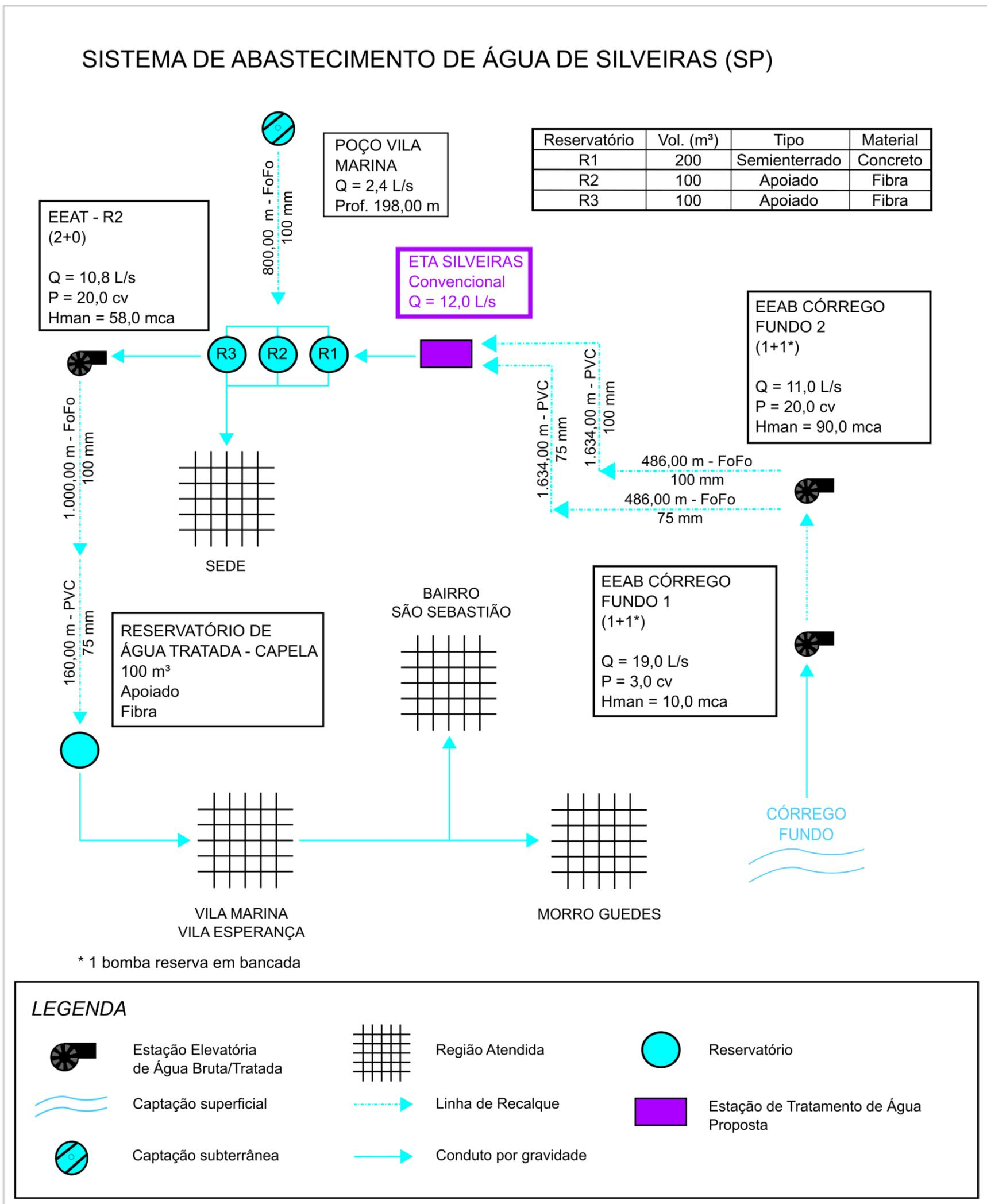
Figura 10.1 – Croqui do Sistema de Abastecimento de Água proposto para Sede
