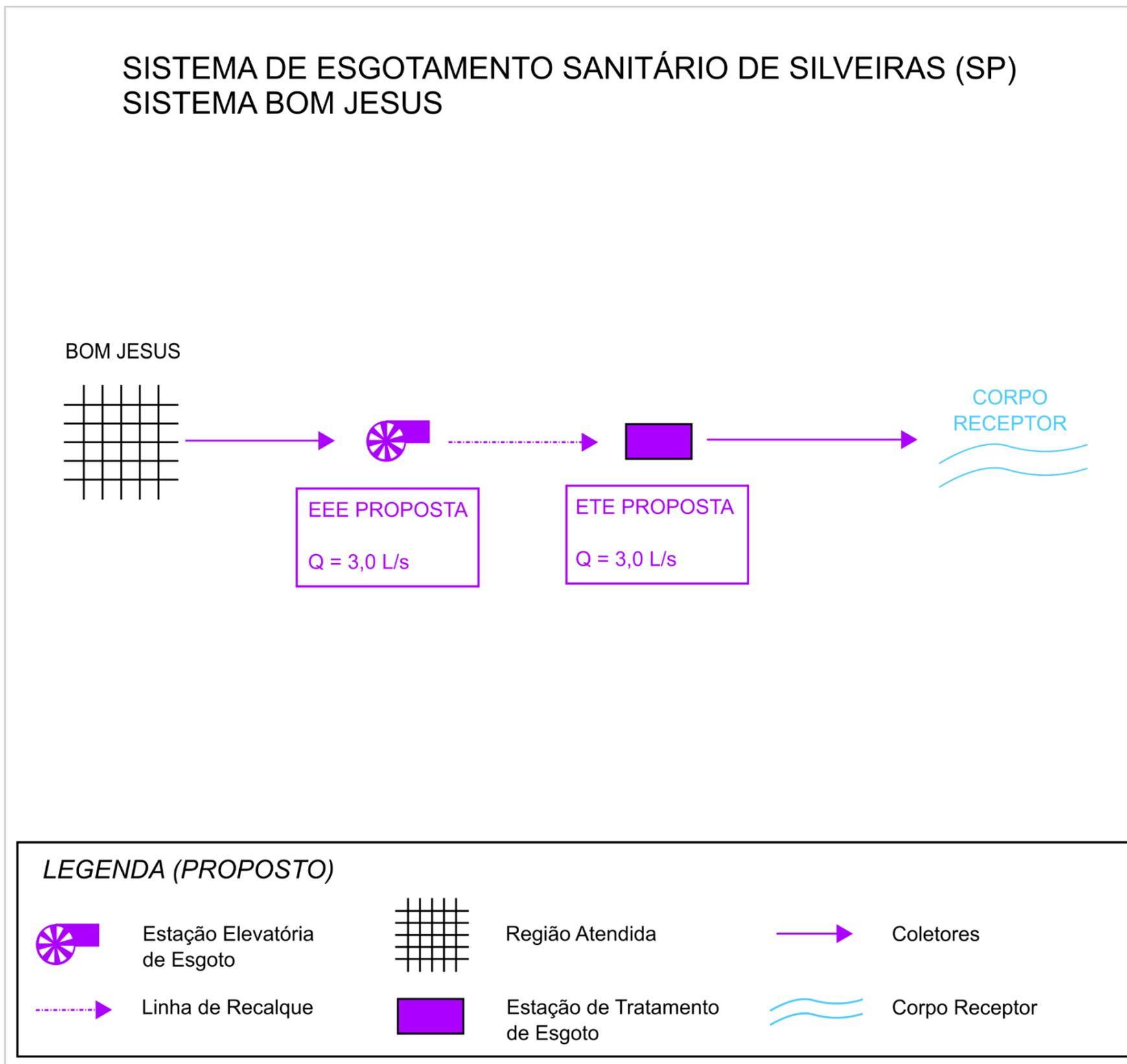
Figura 10.6 – Croqui do Sistema de Esgotamento Sanitário Bom Jesus proposto.
