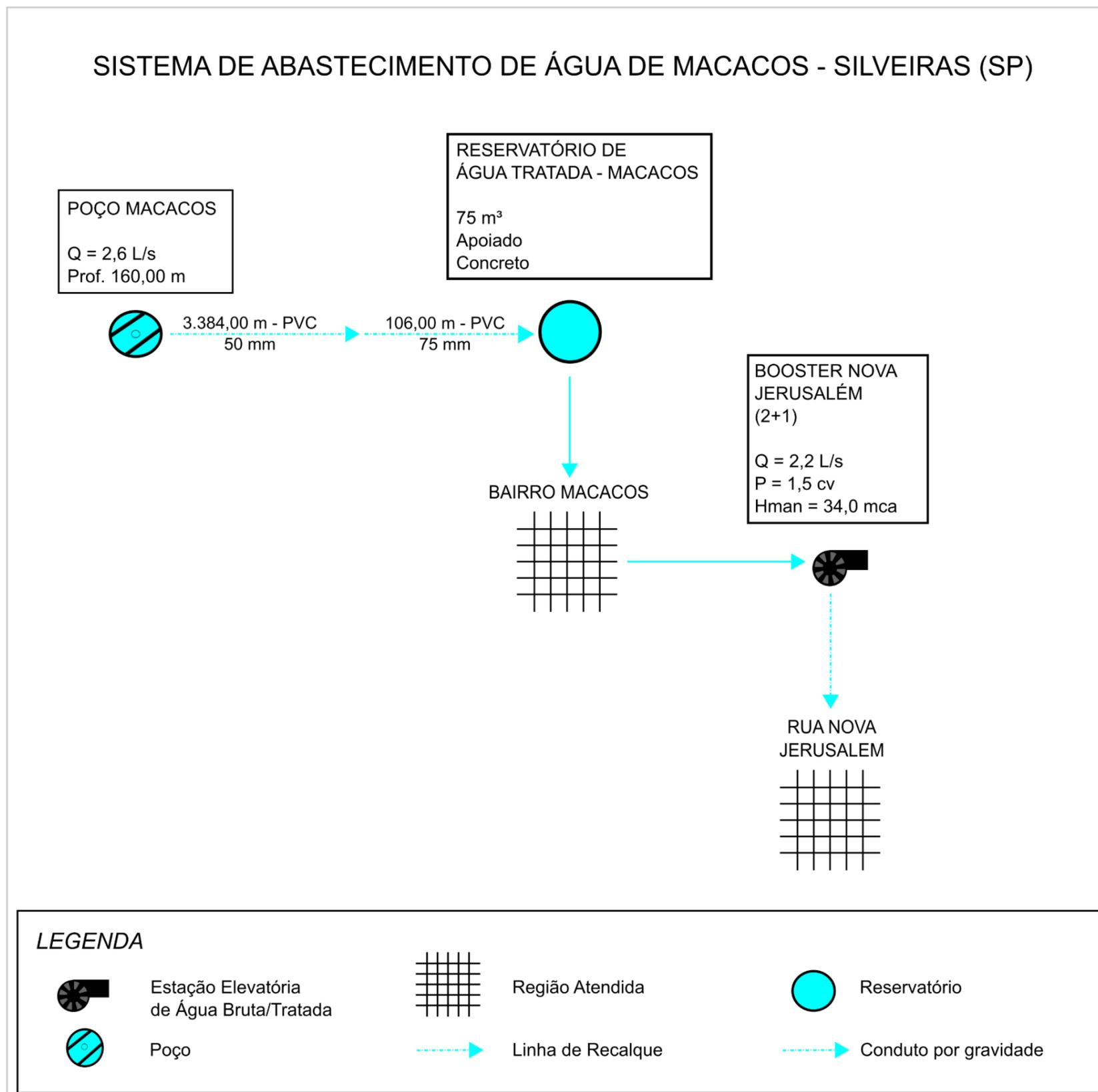
Figura 4.2 – Croqui do Sistema de Abastecimento de Água Macacos
