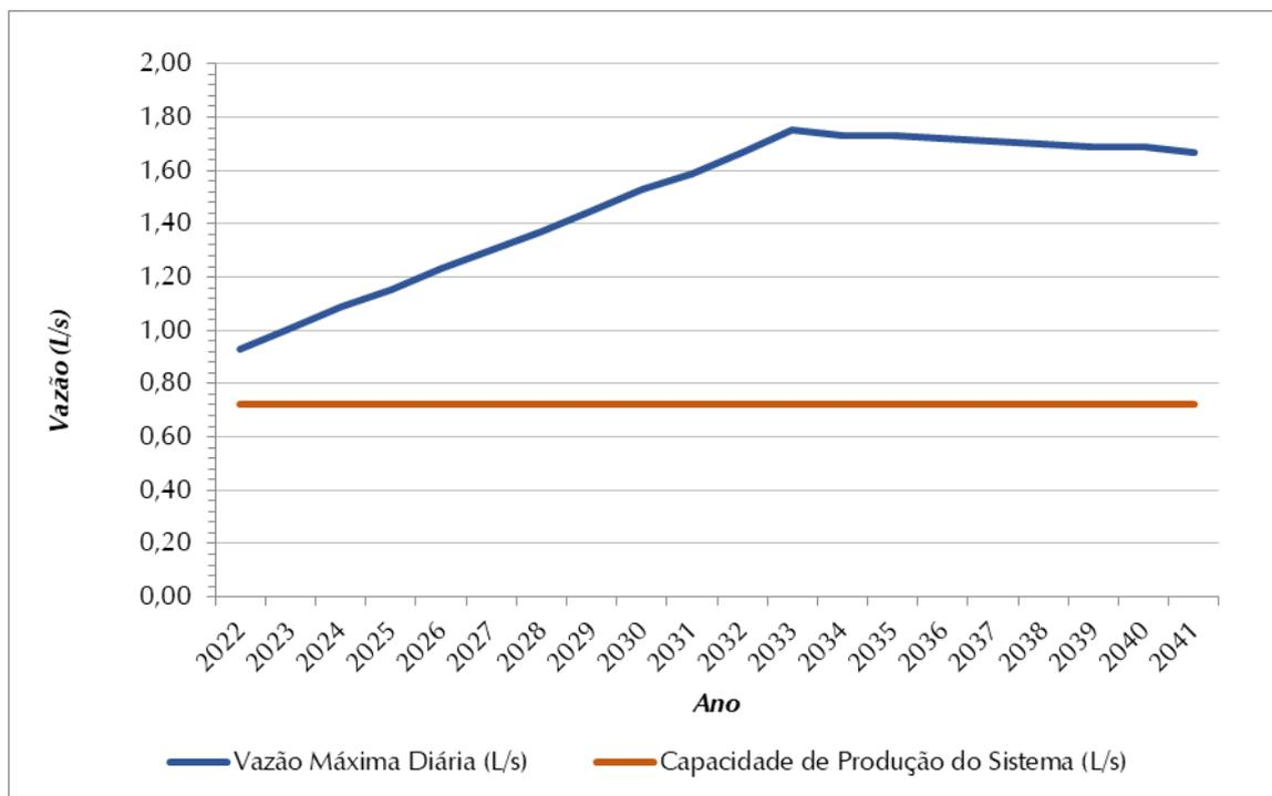
**Figura 8.3 – Demandas Máximas Diárias (L/s) X Vazão Captada (L/s) – SAA Macacos**
