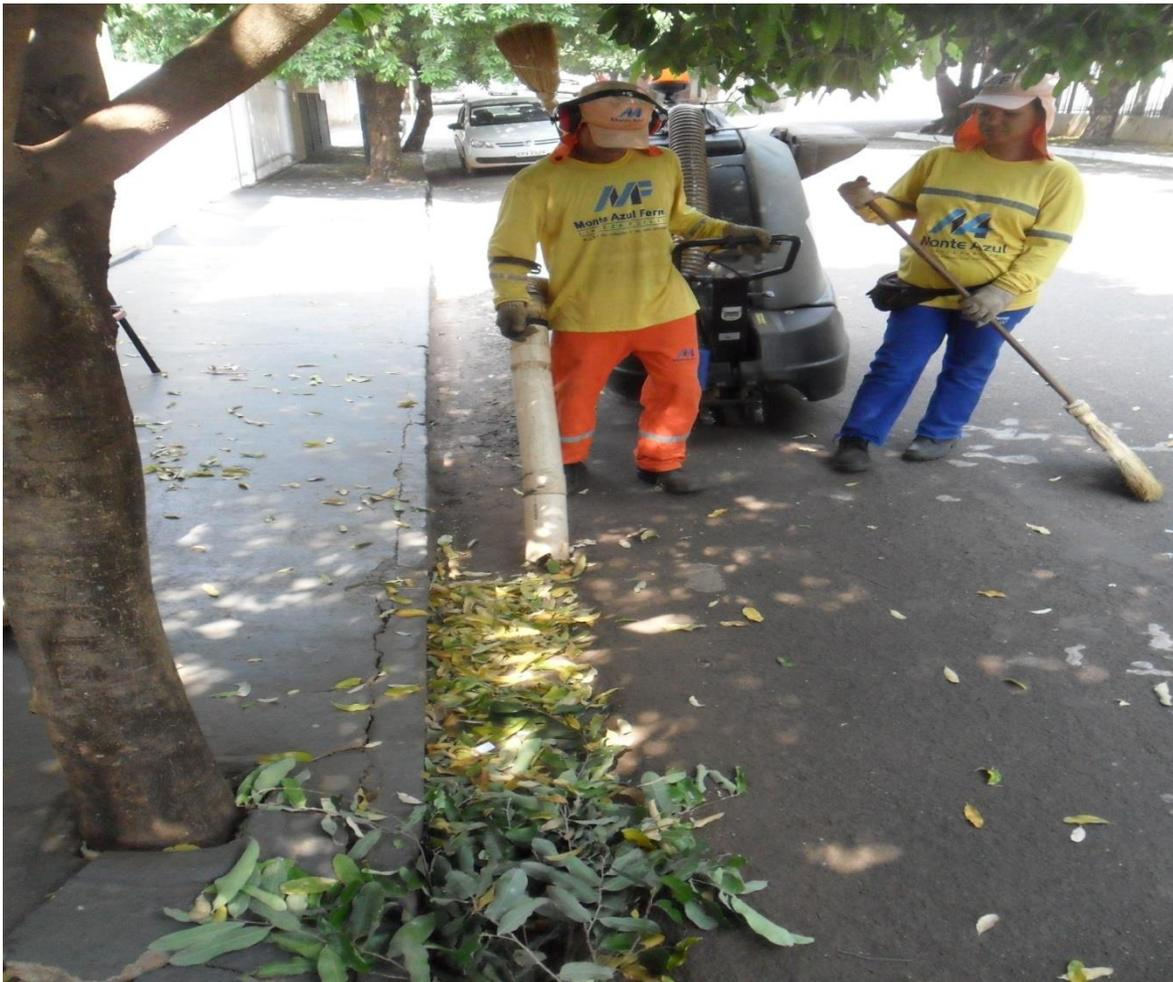
**FOTO : MÁQUINA ASPIRANDO FOLHAS DE ÁRVORES NA VARRIÇÃO MECANIZADA**
