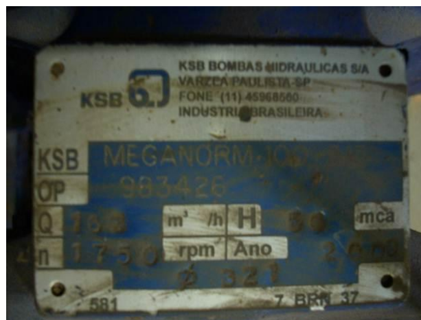
Figura 64 - Especificações técnicas Bombas Real Park ( Q=102 \text{ m}^3/\text{h} H=50\text{mca} 50CV).
