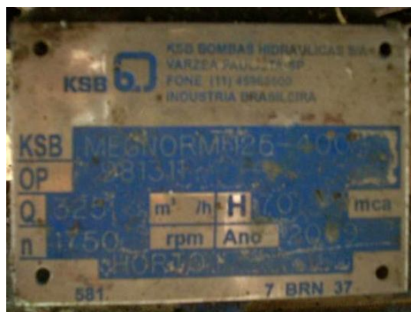
Figura 50 - Especificações técnicas das 3 bombas captação 1 Horto.
