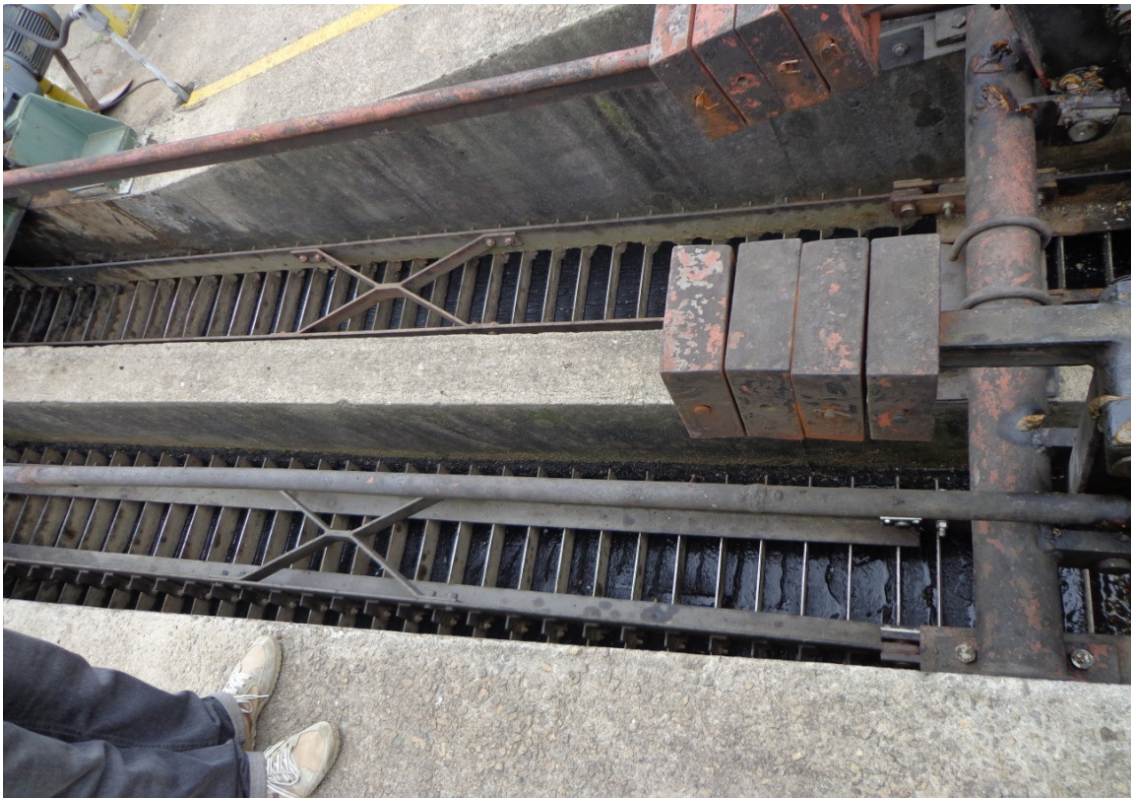
Figura 91 - Classificador de areia (sistema de separação de sólidos grosseiros). Fonte: SMMA, 2013.
