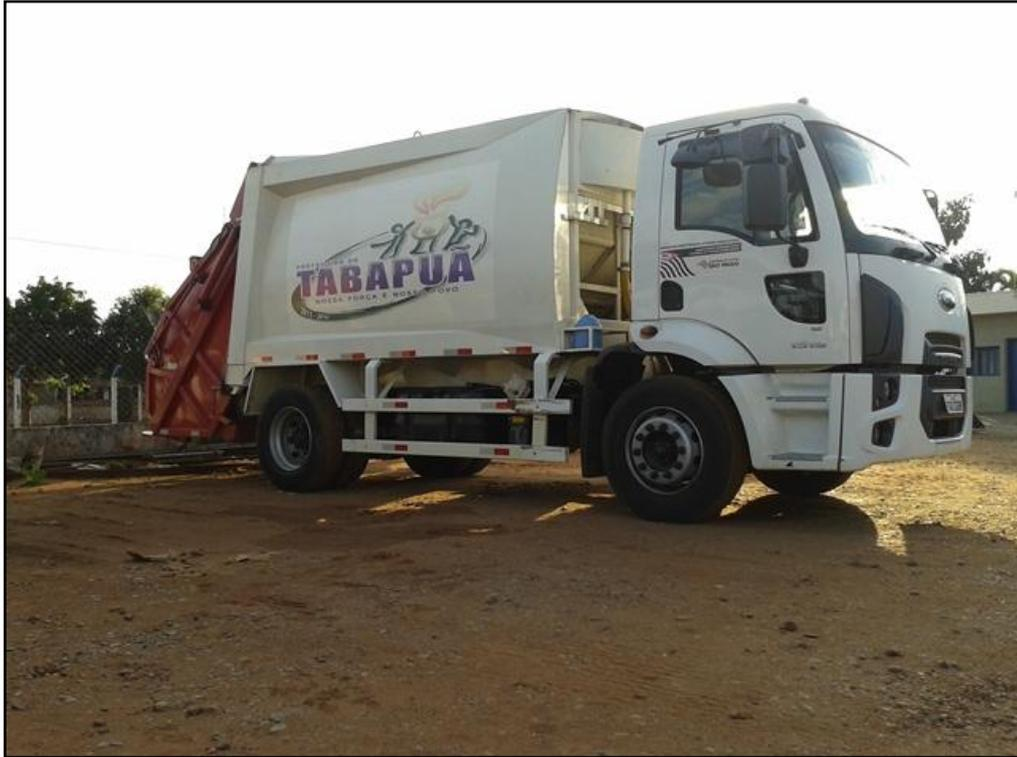
**Figura 5:** Caminhão Coletor Compactador
