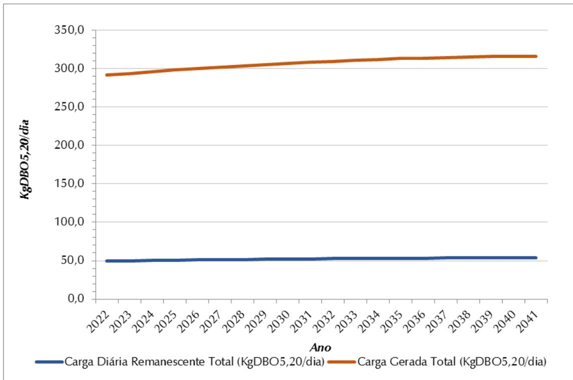
**Figura 8.4 - Evolução de Cargas Orgânicas (Kg DBO<sub>5,20</sub>/Dia) – SES Sede**
