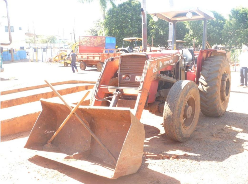
**Figura 26 e 27 – Trator com implemento para a recolha de materiais pesados**
