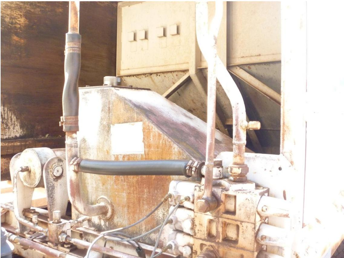
**Figura 15 – Detalhe do sistema hidráulico do caminhão reserva.**
