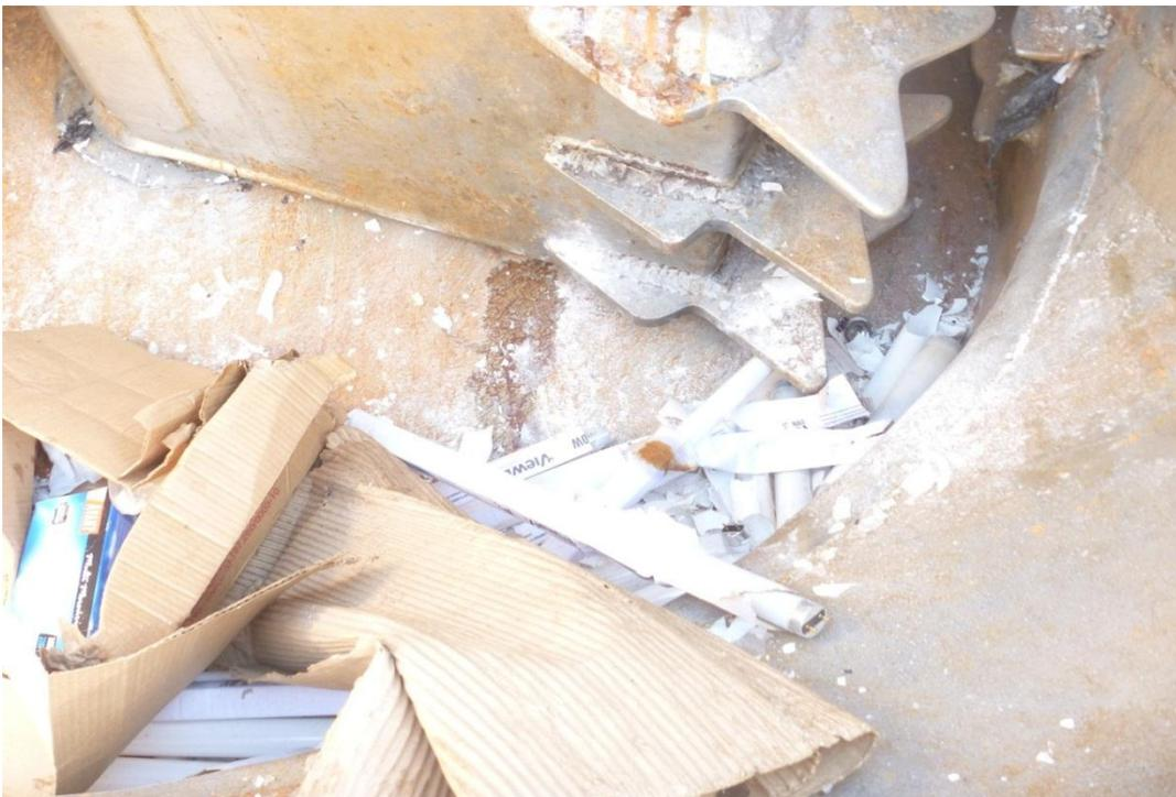
**Figura 38 - Descarte irregular de lâmpadas na prensa do caminhão coletor compactador**
