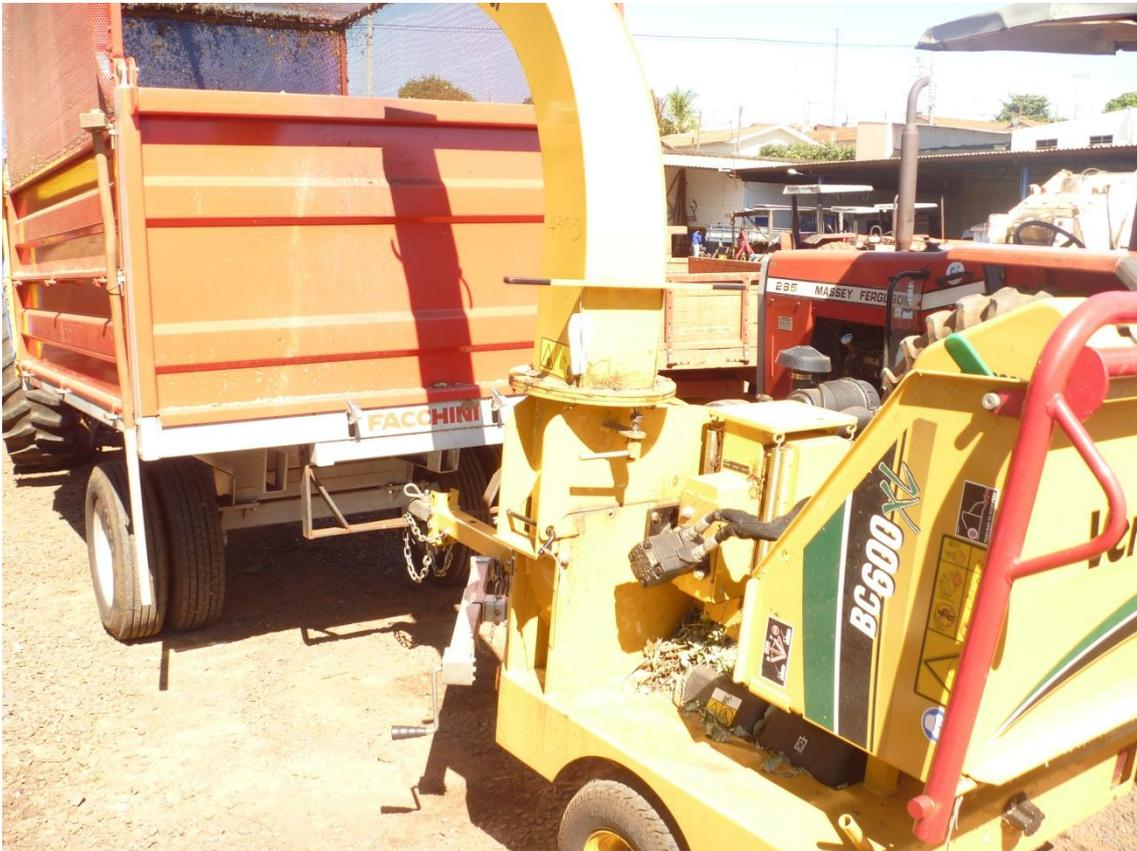
**Figura 24 - Equipamento utilizado no recolhimento e trituração de galhos e massa verde.**
