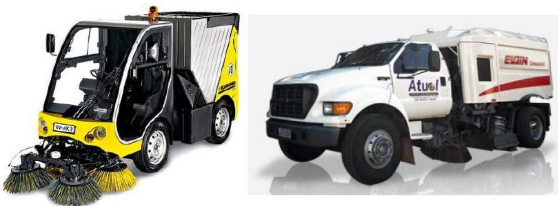
Figura 13: Tipos de varredeiras mecânicas.
