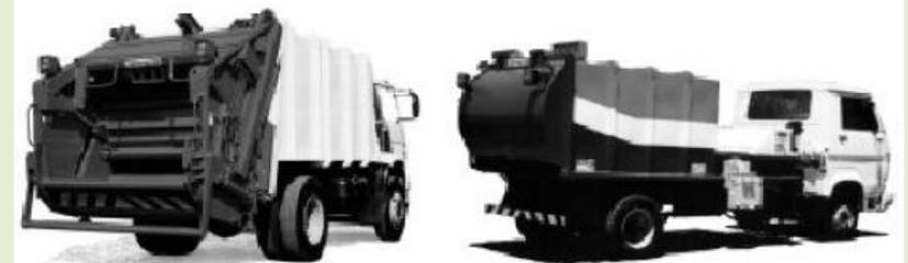
Coletor compactador - 10 a 15 m<sup>3</sup>
