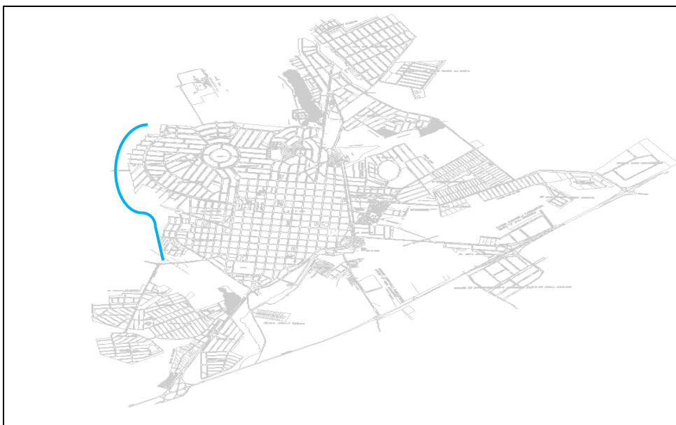
Figura 59- Traçado do novo emissário zona oeste
