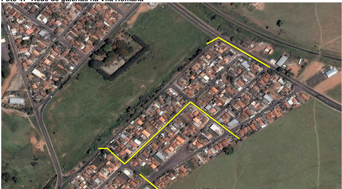
Foto 47- Rede de galerias na Vila Romana
