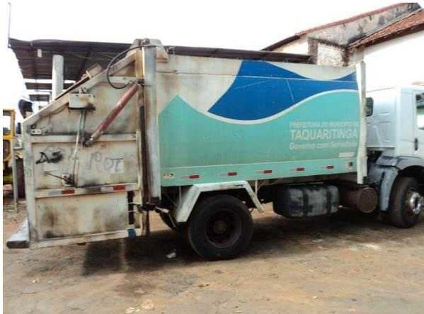
Figura 11.1.3.1. Caminhão coletor compactador Ford Cargo 1722, ano 2007.
