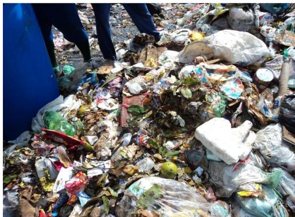
Figura 11.1.1.18. Massa de resíduos homogeneizada com revolvimento da massa após a rasgagem dos sacos.
