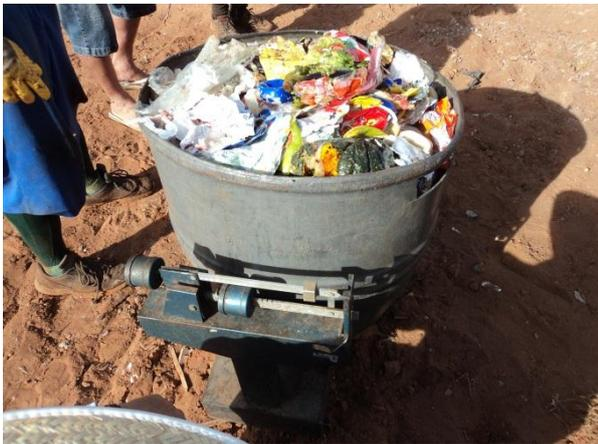
Figura 11.1.1.30. Pesagem total de amostra homogênea escolhida para ser caracterizada.
