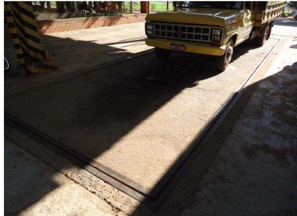
Figura 11.1.2.2. Detalhe de caminhão sendo pesado na balança.
