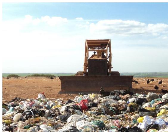
Figura 11.1.3.7. Trator Esteira Fiat Allis D 14 utilizado no aterro sanitário.
