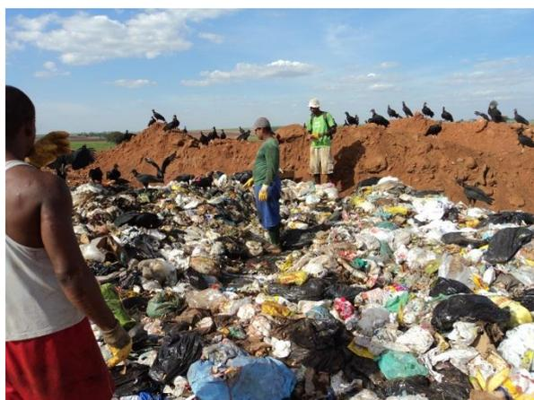
Figura 11.1.1.27. Procedimento de divisão da massa de resíduos em quatro partes iguais.
