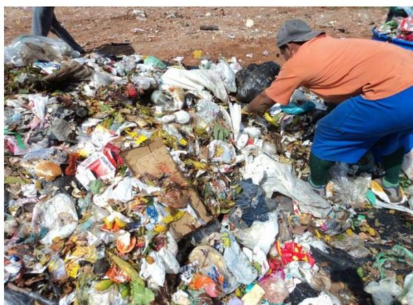
Figura 11.1.1.16. Homogeneização dos resíduos a partir da rasgagem dos sacos plásticos.
