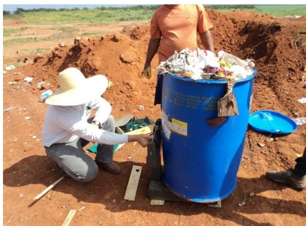
Figura 11.1.1.20. Tambor com massa de resíduos homogênea sendo pesado para depois serem separados todos os materiais.
