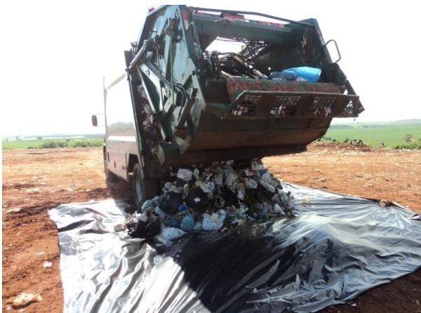
Figura 11.1.1.8. Início do descarregamento em cima da lona plástica.
