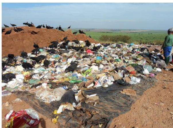
Figura 11.1.1.26. Resíduos espalhados sobre a lona plástica formando distribuição uniforme.
