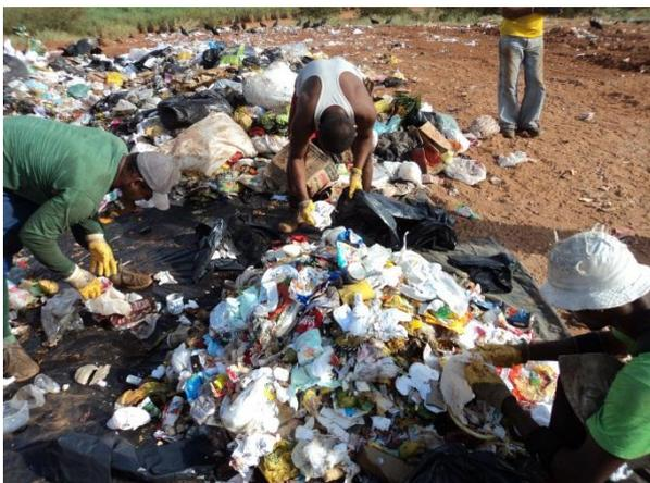
Figura 11.1.1.32. Início da separação da amostra por materiais.
