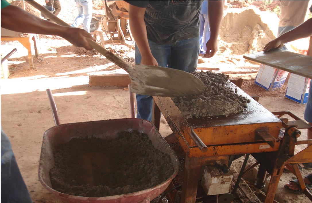
Material já misturado na betoneira e levado a maquina de pavers para da à forma aos pavers.
