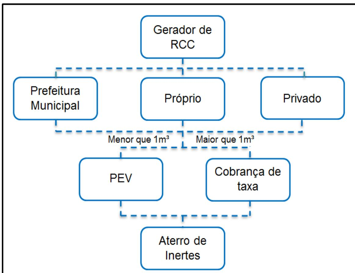
Figura 10.7.1 Modelo proposto para coleta de RCC.
