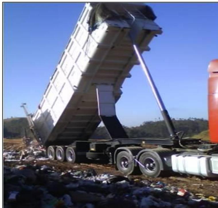
Figura 3.3.1.2.8 - Descarga de resíduo no aterro.
