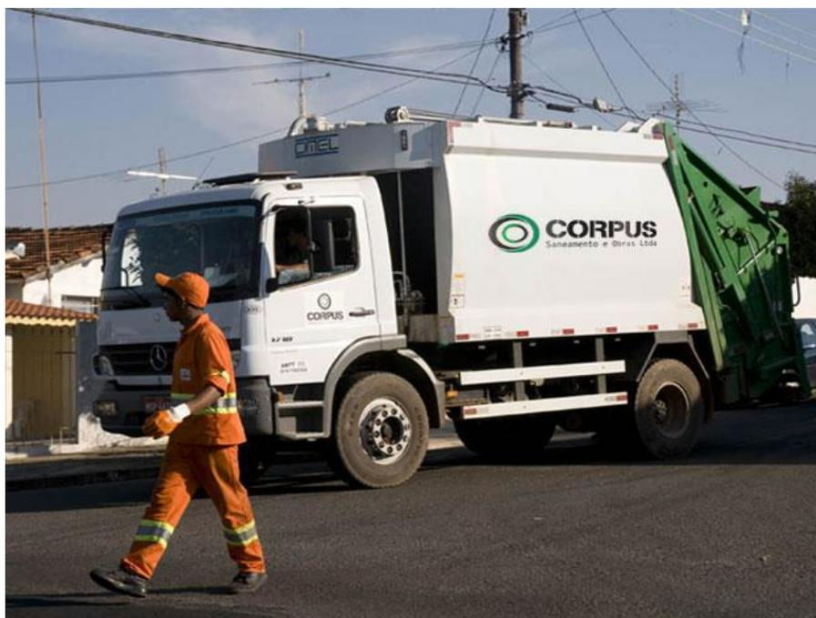
Figura 1: Caminhão utilizado na coleta de resíduos domésticos e comerciais
