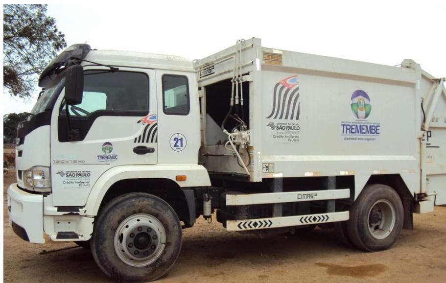
**Figura 5: Caminhão compactador utilizado na coleta de RSD.**
