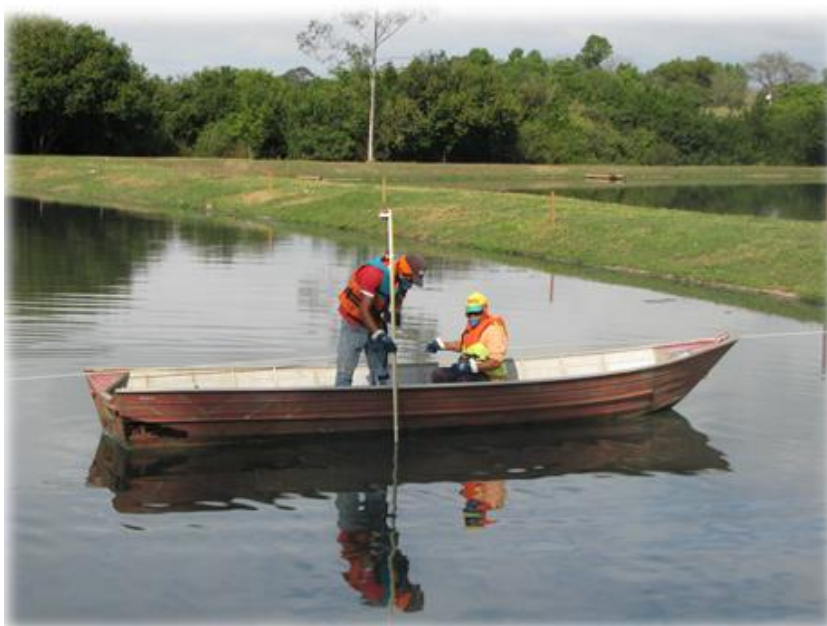
Imagem 10.5: Vista geral do levantamento batimétrico realizado na lagoa anaeróbia.
