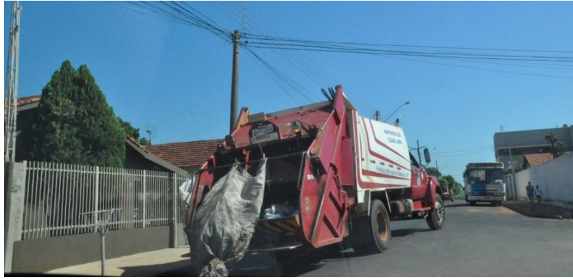
Imagem 8.2: Caminhão compactador utilizado na coleta dos resíduos domiciliares e comerciais em Ubarana.
