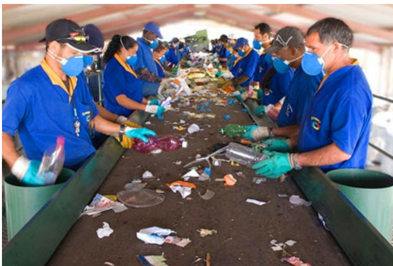
Figura 21– Esteira de Rolagem para Triagem dos Resíduos.
