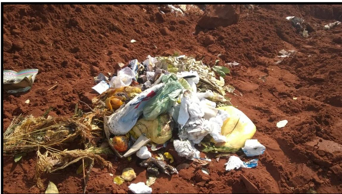
Figura 40 - Separação dos resíduos para análise gravimétrica
