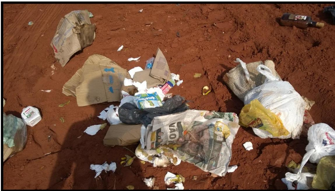
Figura 41 - Separação dos resíduos para análise gravimétrica
