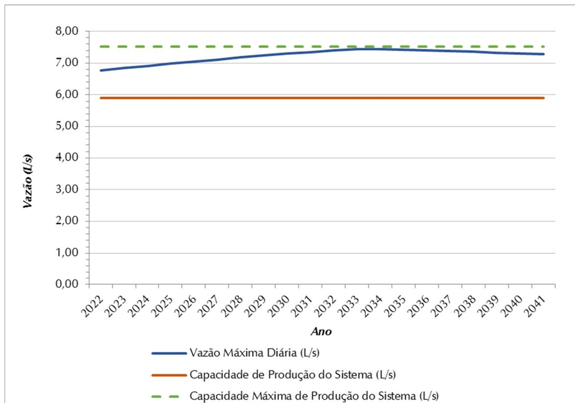
**Figura 8.2 – Demandas Máximas Diárias Atendidas por Urânia (L/s) X Vazão Captada em Urânia (L/s) – SAA Sede**
