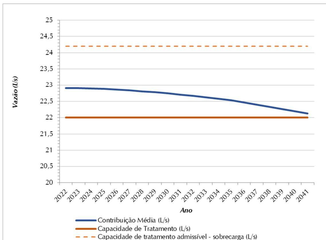
**Figura 8.4 – Contribuição Média Total (L/s) x Capacidade de Tratamento de Esgoto (L/s) – SES Sede**
