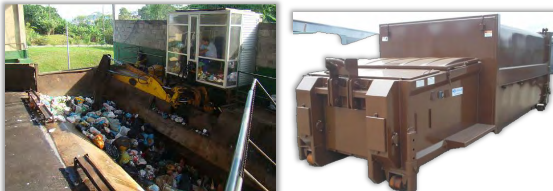
Figura 8.68 - Compactação dos Resíduos com Braço mecânico e Caixa estacionárias compactadora
