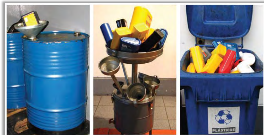
Figura 8.47 – Equipamentos para escoamento e armazenamento temporário de óleo lubrificante
