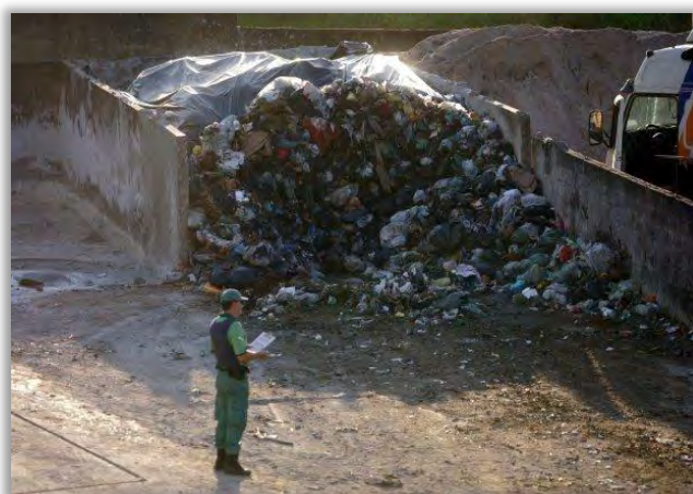
Figura 8.69 – Estação de transbordo com silos de armazenamento sem compactação
