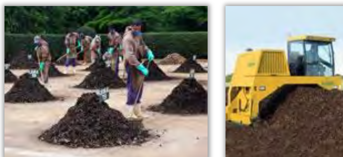
Figura 8.75 - Revolvimento Manual e Mecânico de leiras
