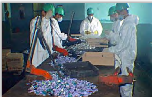
Figura 7.104 – Pilhas em processo de corte para separação dos materiais
