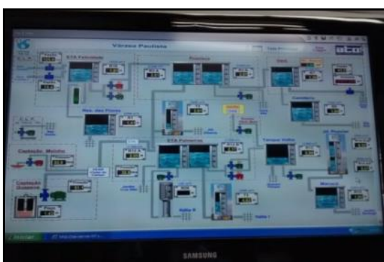
Figura 40 - Monitor de Telemetria para acompanhamento do nível dos reservatórios do SAA e instalações.
