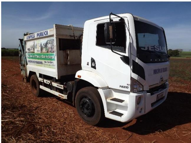
Foto 3.67 – Vista do caminhão coletor compactador utilizado na coleta regular
