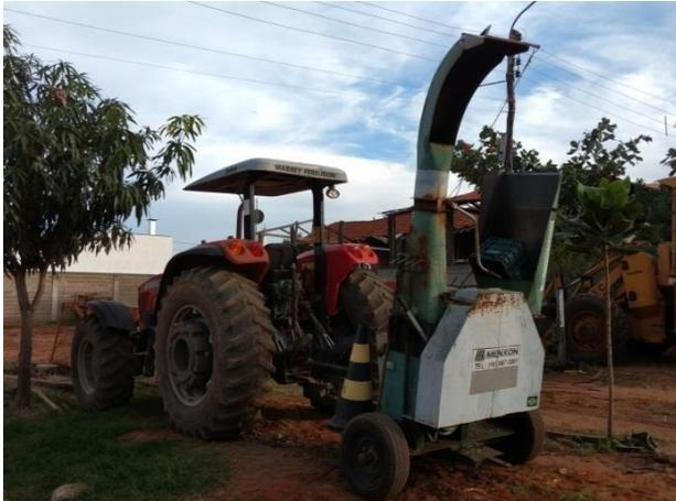
Foto 1.8 – Trator e picador de galho acoplado
