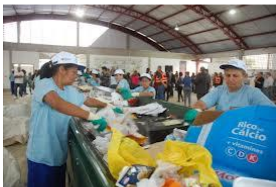
Figura 14: Esteira de triagem dos materiais.
