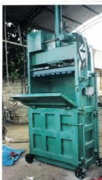
Figura 15: Prensa para compactação de materiais recicláveis.
