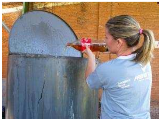
Figura 145: Detalhe de abastecimento no decantador de óleo.
